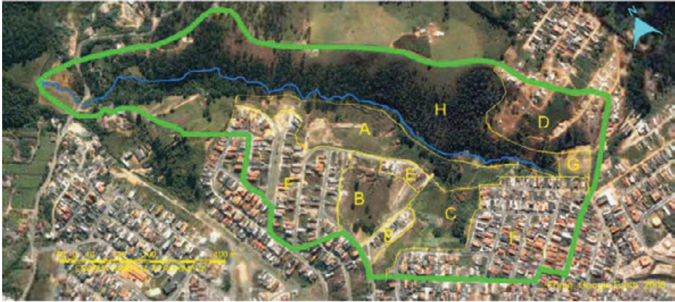
Sub-bacia do Pau d'Alho. Montante à direita, jusante à esquerda. Toda a vertente esquerda foi terraplenada para produção de áreas planas, com imensos volumes de solo sendo lançados sobre o talvegue do córrego. Esses serviços estão associados à implantação do Loteamento Continental 3, oficialmente aprovado na Prefeitura de Guarulhos. Junto à cabeceira, Setor D, a Vila Operária, ocupação irregular formada por processo de invasão. Ambas as modalidades de expansão urbana, a oficial e a irregular, provocaram processos erosivos em larga escala. (Foto do Autor)
