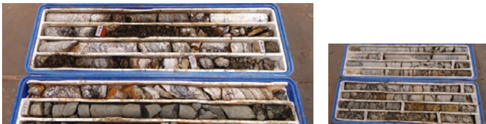
Figura 3 e 4 - Aspectos típicos dos testemunhos de sondagem rotativa recuperados. (Fotos do Autor)
