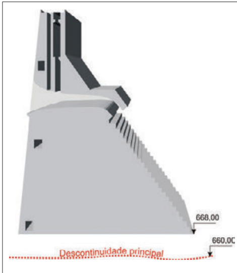
Figura 3 – Situação das escavações no final de 2007, quando afloraram as descontinuidades sub-horizontais que condicionaram a estabilidade ao deslizamento ao longo dessas feições. As setas brancas indicam as feições. A lupa indica a posição ampliada no canto esquerdo superior, mostrando a descontinuidade que deu origem à situação descrita. (Fonte: Ricardo Antônio Abrahão)
