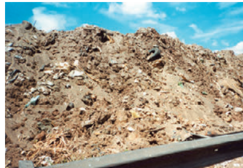
Figura 7 – Detalhe do material de desassoreamento 95% sedimentos e 5% lixo, em peso. (Foto do Autor)
