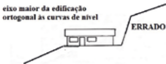
DISPOSIÇÃO DO LOTE E DA EDIFICAÇÃO EM RELAÇÃO ÀS CURVAS DE NÍVEL Geól. Álvaro Santos
